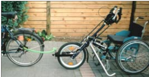
545 Barra de arrastre para Handbikes Sistema de enganche en que la handbike puede ser arrastrado por una bicicleta común (para los modelos City7, City KID, y los modelos Ultra).
