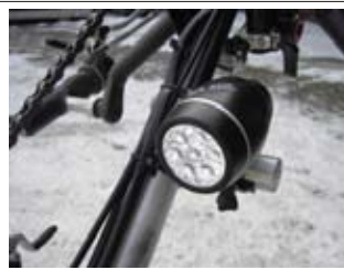
410/3 LED lampara Con pilas, 7 LED incl. Adaptador para handbikes.
